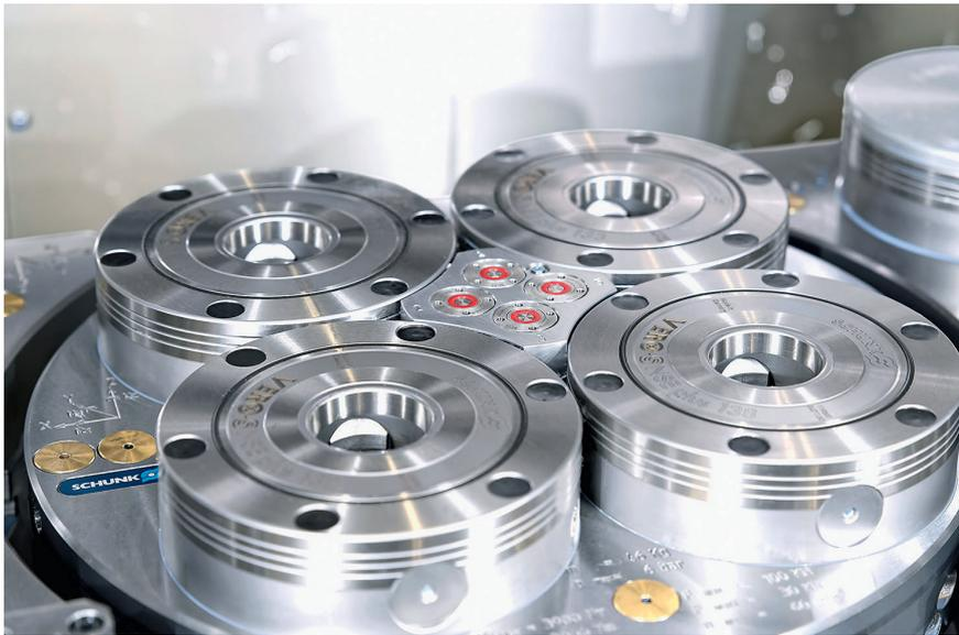
2 Die Bauhöhen der Vero-S NSE plus Nullpunktspannmodule und der anwendungsspezifischen Medienübergabe in der Mitte sind exakt aufeinander abgestimmt © Schunk
